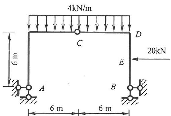
六. 用力法计算图示刚架(各杆 EI 注于杆侧), 作弯矩图和剪力图(注意对称性的利用)。(25分)
