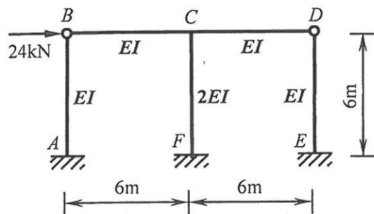
七. 用位移法做出图示结构的弯矩和剪力图。(30分)
