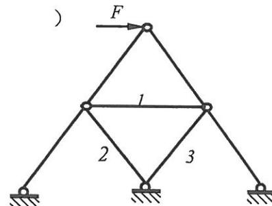
4. 图 a 所示结构, 取图 b 为力法基本结构, 则其力法方程为
